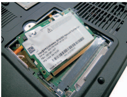
3. Устанавливаем беспроводной модуль...
