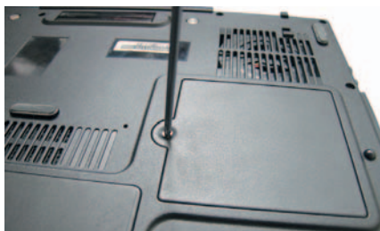
1. Отворачиваем винт крепления крышки отсека расширения и снимаем ее
